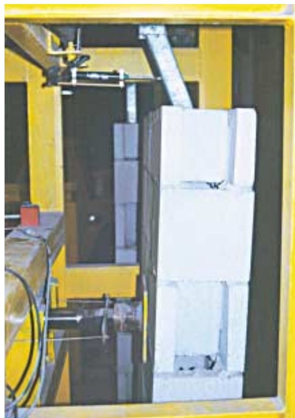
Figura 18 Prova sperimentale di resistenza di una staffa di sommità.
