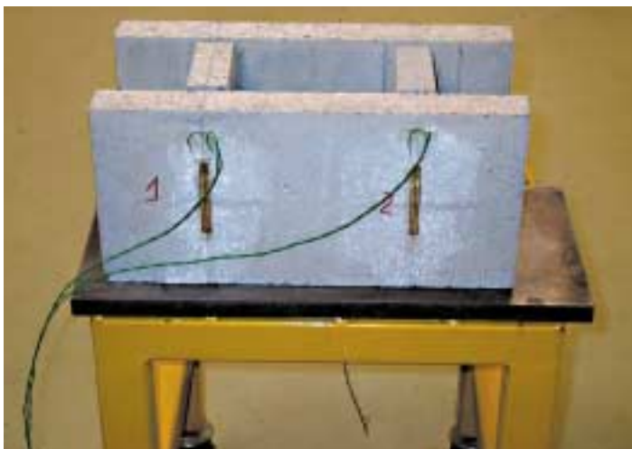
Figura 10 Elemento predisposto con Strain Gauge per la determinazione della funzione \sigma = f(\epsilon) . I dati vengono rilevati da specifiche apparecchiature elettroniche, asservite a computer, che con un programma di "regressione matematica" di tipo esponenziale esprime la funzione in termini analitici, funzione necessaria per il calcolo flessionale della strutturazione allo stato limite ultimo.
