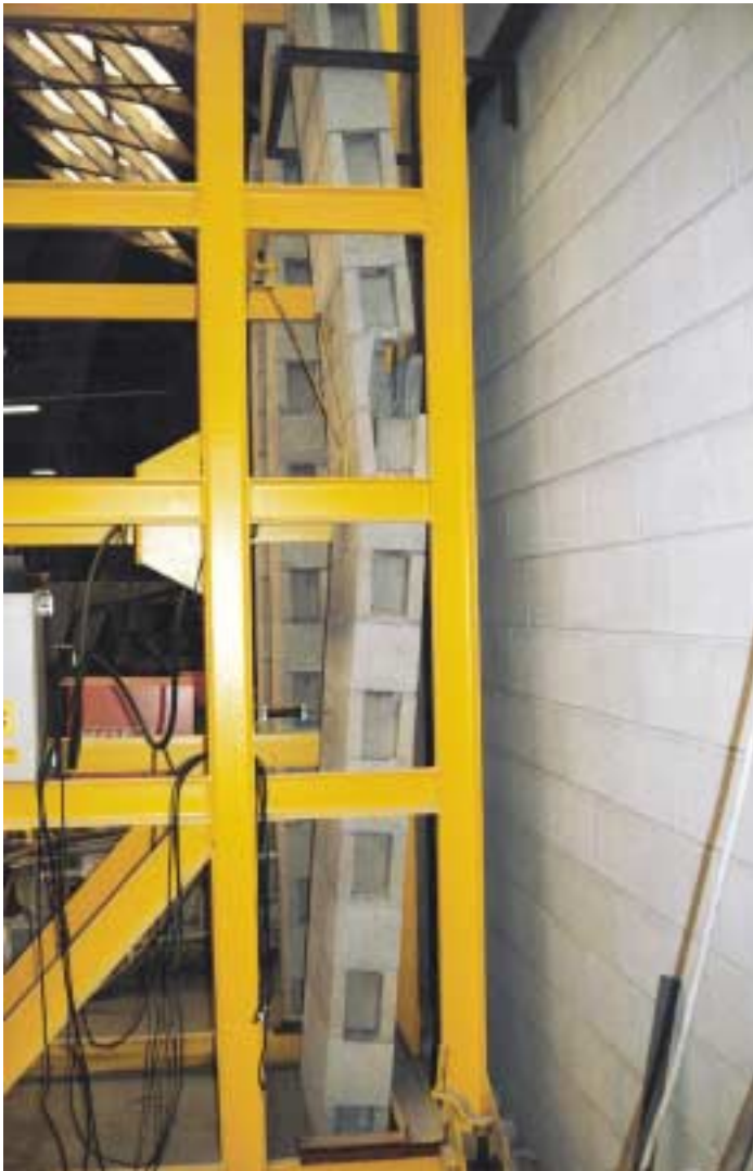
Figura 16a Prova a flessione di una strutturazione nei Laboratori Vibrapac (di dette prove si dispone di certificati ICITE).
